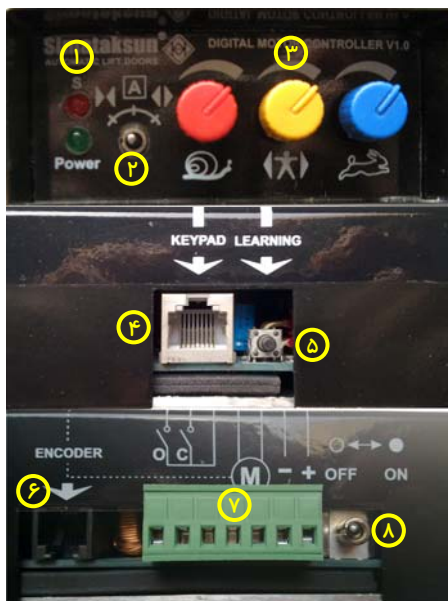
شکل شماره ۲- اجزای کنترل درب
